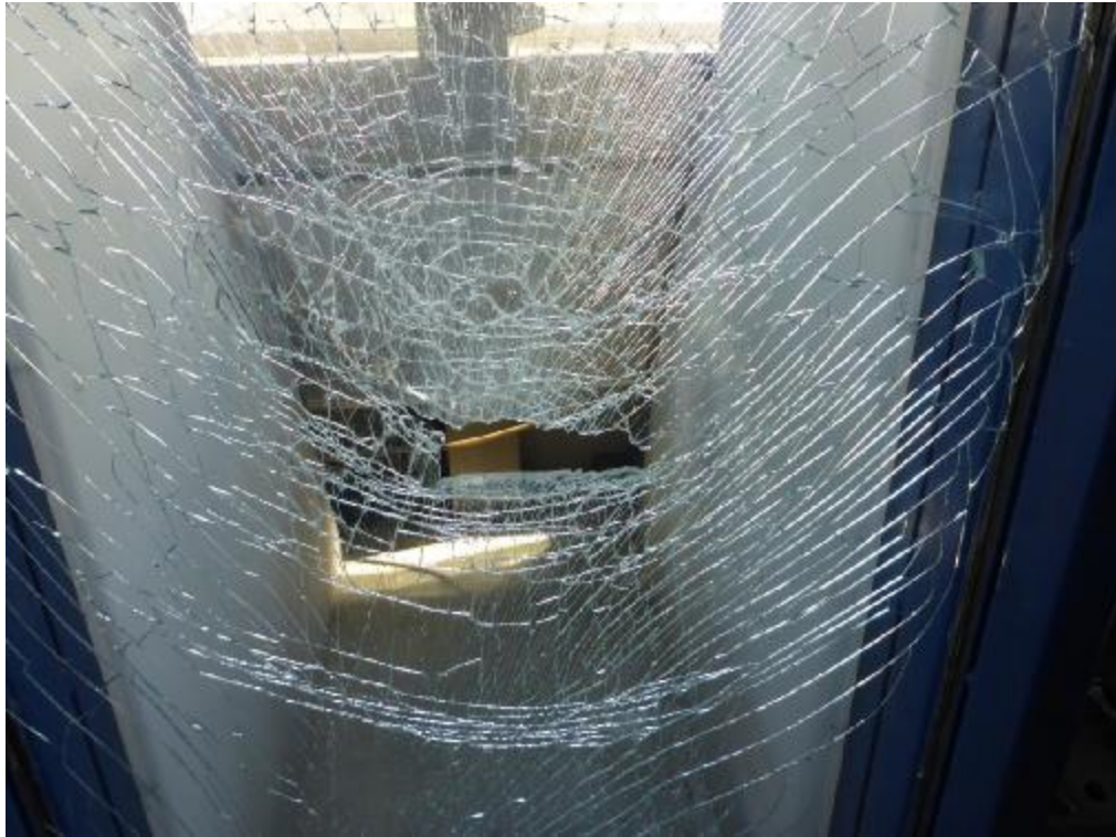
Abb. 2: Probekörper 2 mit Bruchverhalten vom Typ B
