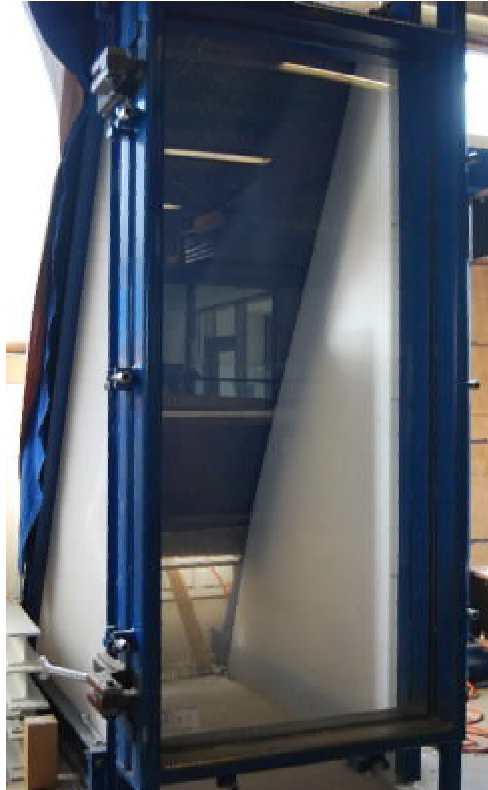
Abb. 1: Pendelrahmen mit Probekörper
