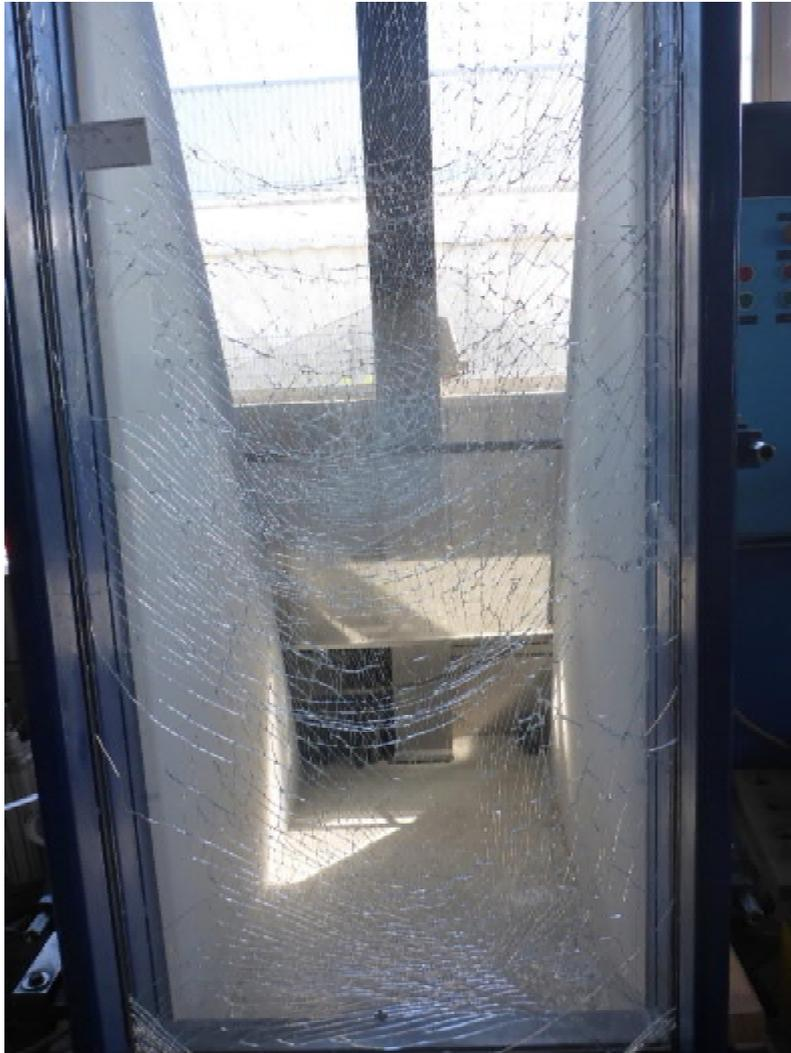
Abb. 2: Probekörper 14 mit Bruchverhalten vom Typ B
